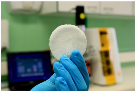
Abb. 2: Wundauflage (Nonwoven/Vlies) aus Alginatefasern bakterieller Quelle. Bakterielle Alginate-Vliese nehmen bis zu 70% mehr Flüssigkeit auf als marine Alginate-Vliese.
