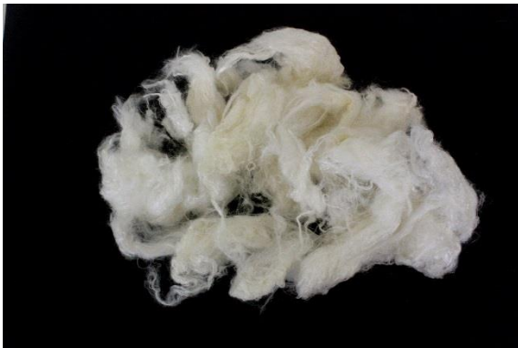
Abb. 1: Alginate-Viskose-Fasern, hergestellt mit bakteriellem Alginat.
