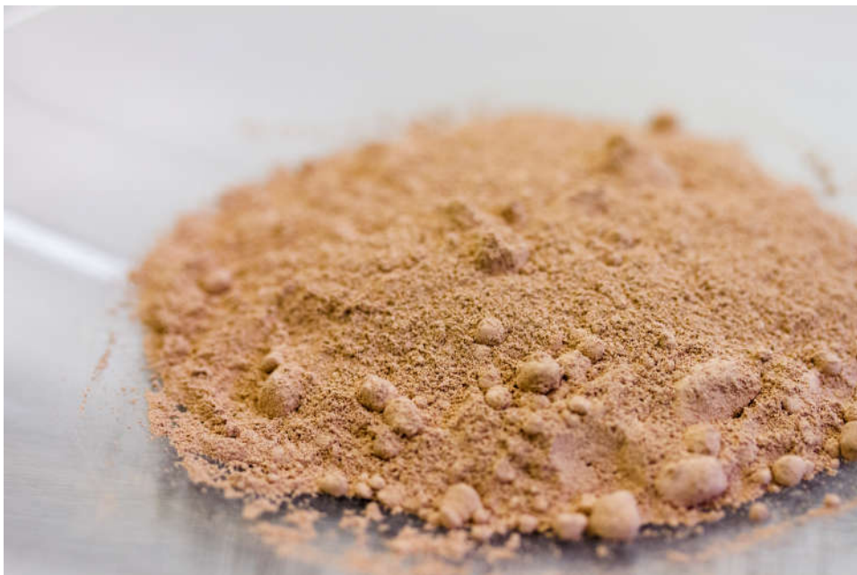
Feingemahlener Golderz für die biologische Aufbereitung mit dem von BRAIN und CyPlus entwickelten Green-Mining-Verfahren.
